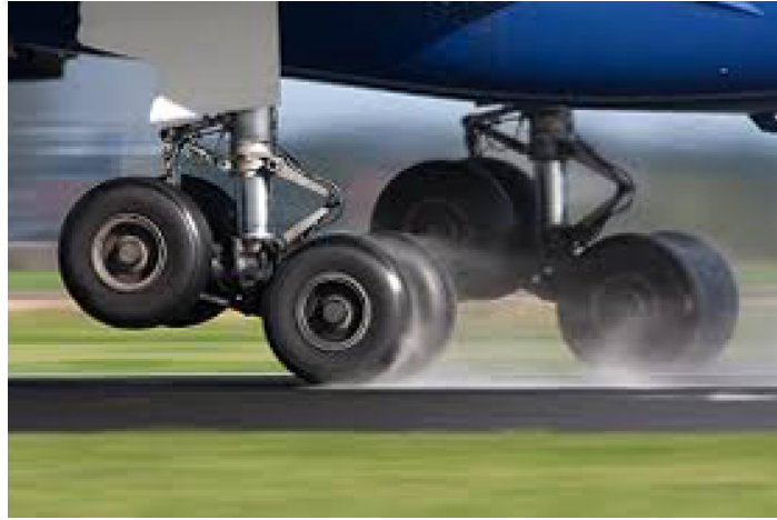
Figure 17 : frottement dynamique et usure des pneus à l'impact
