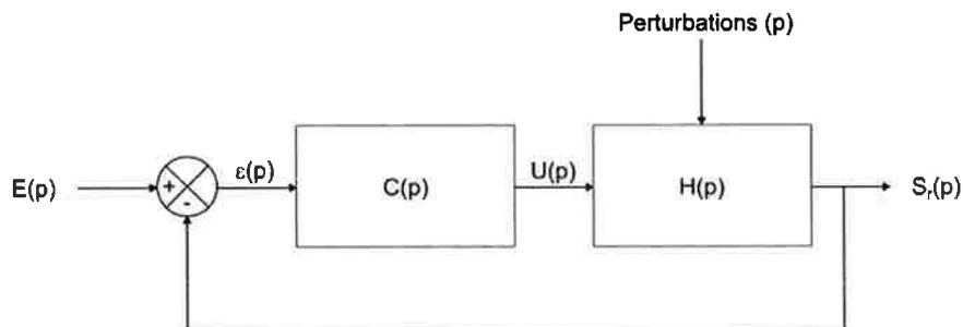
**Figure 2 :** Schéma bloc modélisant le système.  $E(p)$  représente l'entrée,  $S(p)$  la sortie,  $U(p)$  la commande, Perturbations ( $p$ ) les perturbations appliquées au système,  $\varepsilon(p)$  l'erreur,  $H(p)$  le système et  $C(p)$  le correcteur.  $p$  représente la variable de Laplace.
