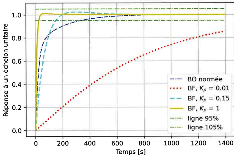
**Figure 3 :** Réponse des différents correcteurs pour un échelon de consigne en boucle fermée (BF). La réponse indicielle du système en boucle ouverte (BO) a été tracée pour permettre une comparaison des performances.
