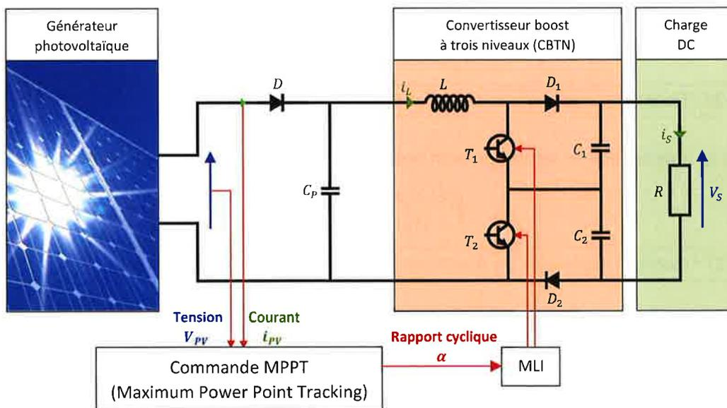
Figure 14 : Schéma de la commande du MPPT
