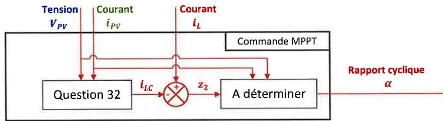
Figure 16 : Architecture de la loi de commande MPPT
