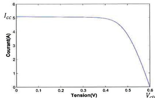
**Figure 6 :** Caractéristique courant-tension d'une cellule photovoltaïque
