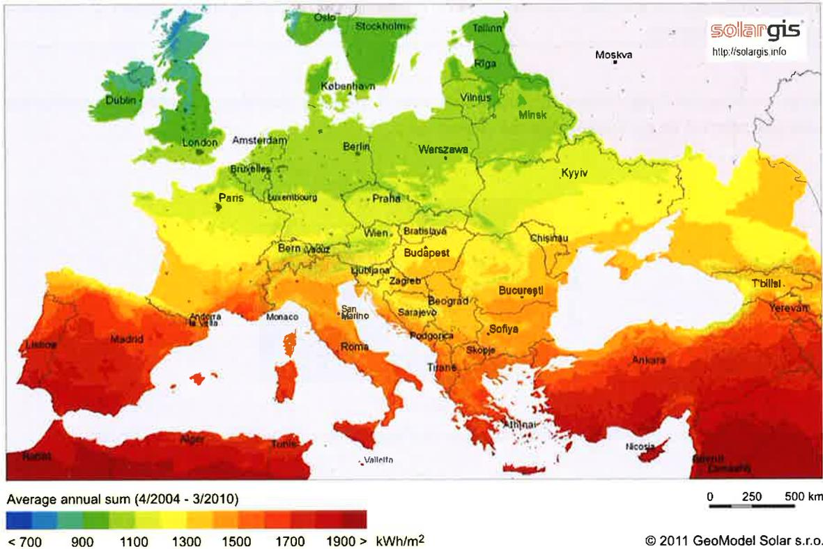
Carte de l'irradiation solaire globale : Energie (kWh) reçue par un panneau photovoltaïque de 1 m<sup>2</sup> orienté dans des conditions optimales, en 1 an.
