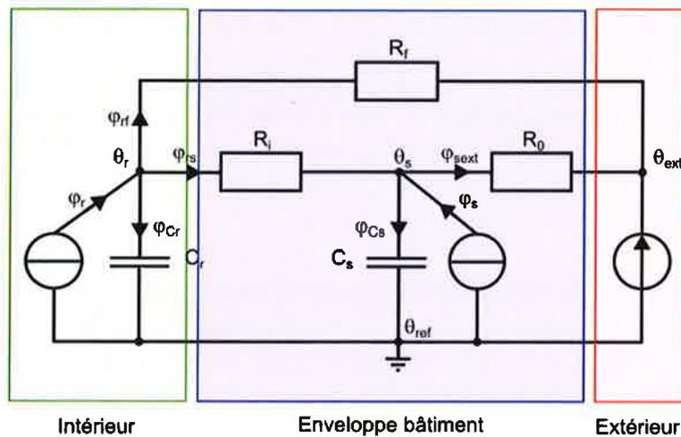
**Figure 1 :** Représentation d'un bâtiment par un schéma équivalent  $R_3C_2$ . Les différents éléments équivalents passifs et les générateurs de courant et le générateur de tension sont pris en convention générateur.
