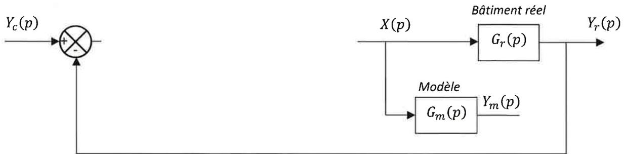
Figure 22 : Schéma bloc (incomplet) de la commande prédictive
